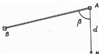
Рис 13 Вынос на местность проектной точки способом полярных координат
